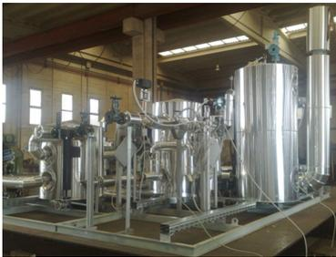
**Fig 3:** impianto di prova di sistemi solari a media e bassa temperatura
