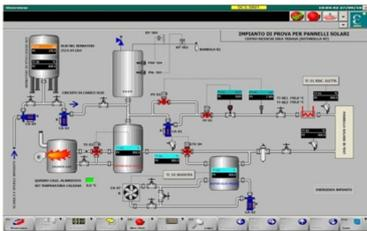
**Fig 4:** Schermata del software di gestione e controllo dell'impianto di prova
